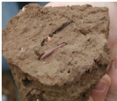
Mottes de type Gamma ( \Gamma ) : beaucoup de macroporosité visible à l'oeil
