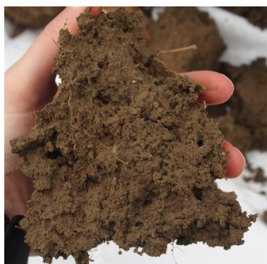
Mottes de type Gamma ( \Gamma ) : beaucoup de macroporosité visible à l'oeil
