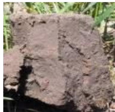
Mottes de type Delta ( \Delta ) : aucune macroporosité visible à l'oeil
