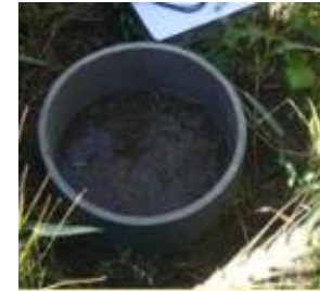
Mesure de l'infiltration de l'eau dans le sol : mesure par infiltromètre (à gauche) ou Beer Khan (à droite)
