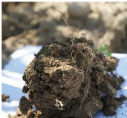
Mottes de type Gamma ( \Gamma ) : beaucoup de macroporosité visible à l'oeil
