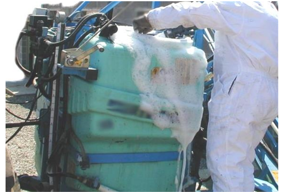
Incident de compatibilité des produits (mousse) - débordement
